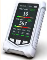
جهاز متعدد الأغراض لقياس ملوثات الهواء والرطوبة ودرجة الحرارة
